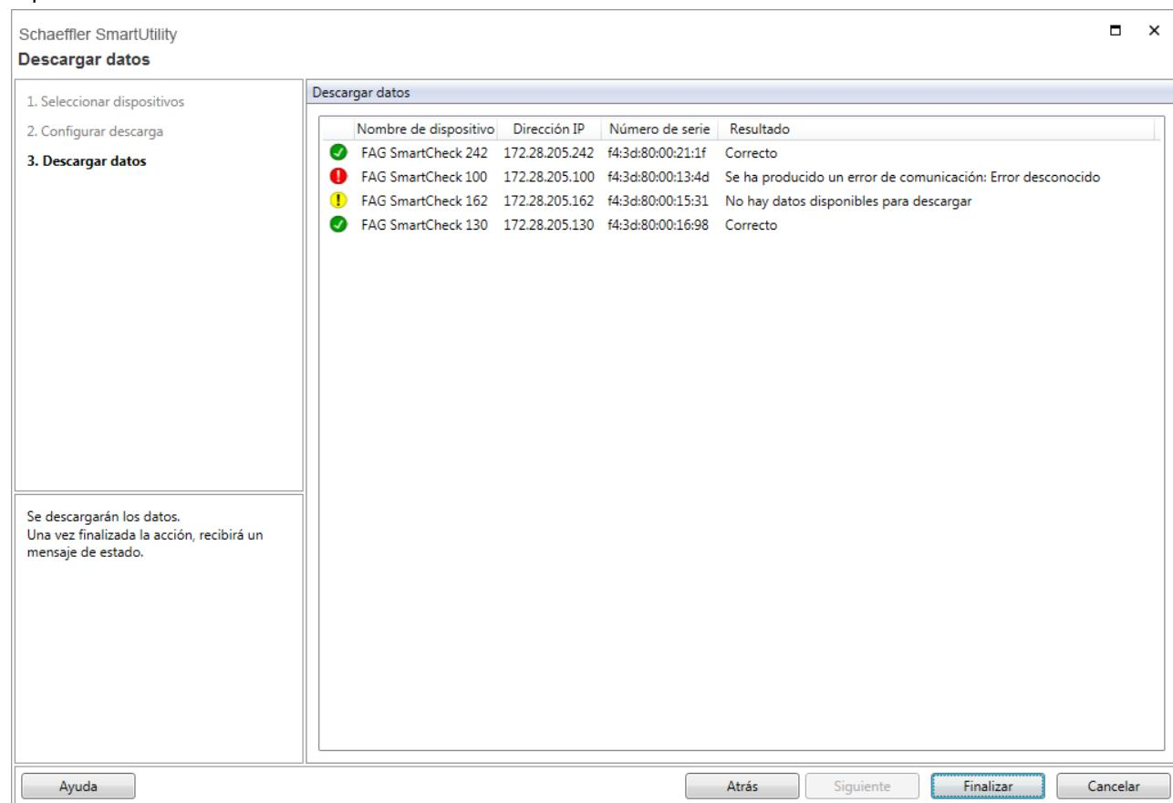
Los datos de medición descargados se transferirán a la base de datos en la que se guardan los datos de todos los dispositivos. Esta base de datos se establece en **Ajustes** . El directorio de la base de datos se puede ver a través del asistente **Abrir directorio de la base de datos** .
