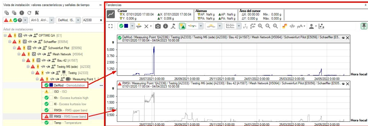
Con cada tendencia adicional abierta se adapta el Viewer de señal de tiempo y de espectro: Para cada tendencia cargada se carga la última señal de tiempo disponible en el Viewer de señal de tiempo y de espectro.
