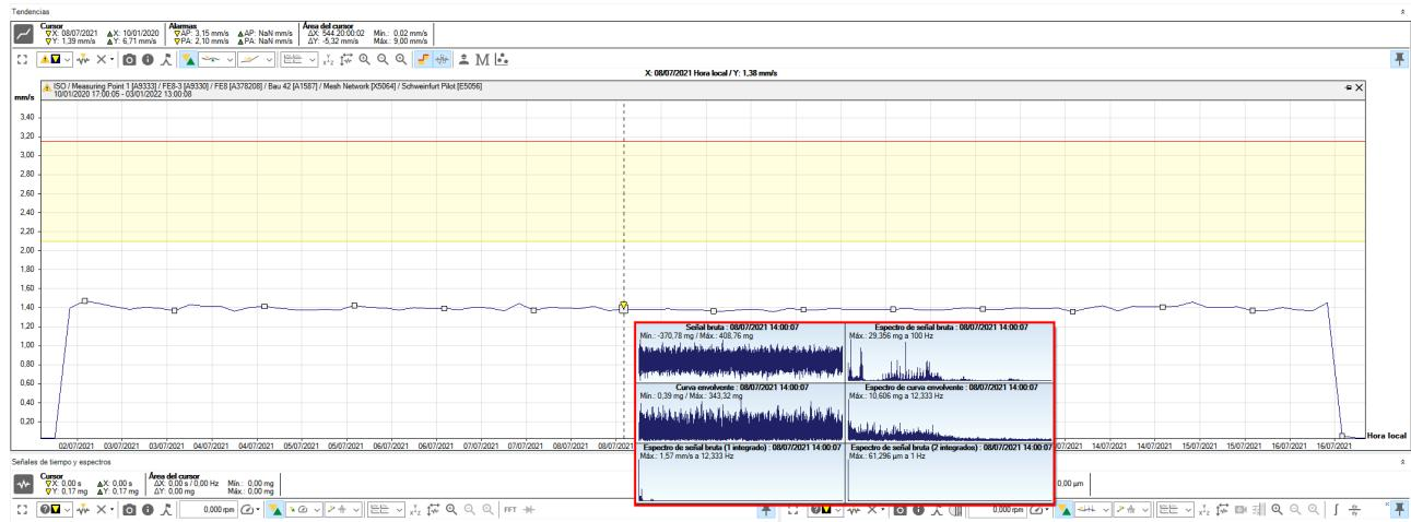
3. Haga doble clic en el marcador de señal de tiempo para cargar el diagrama correspondiente en el Viewer de señal de tiempo y espectro:
