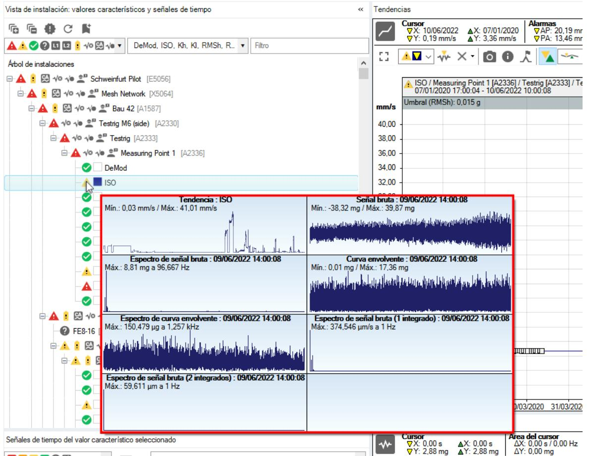
No se muestra ningún estado de alarma para los nodos del árbol de equipos.
